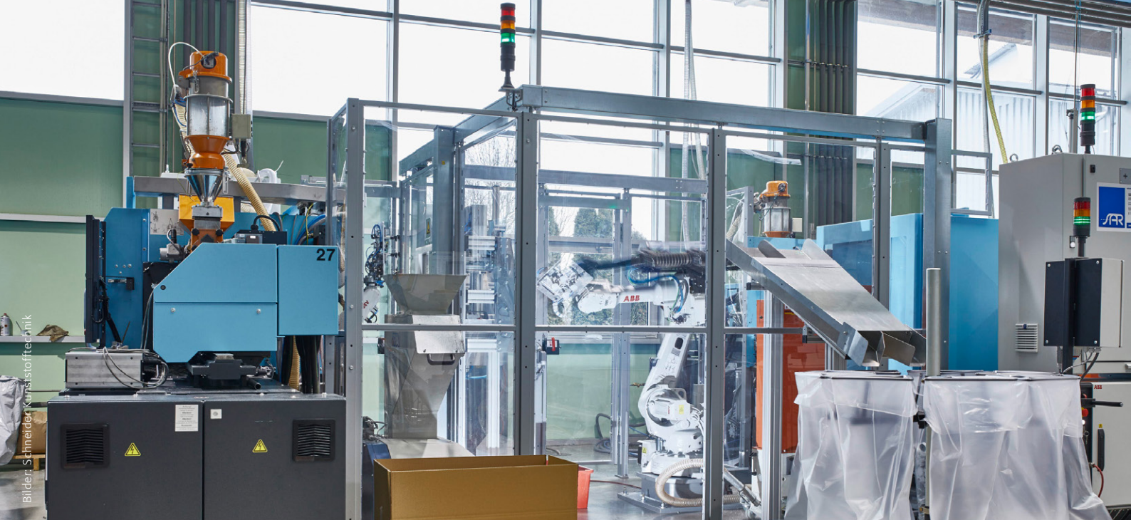
In dieser Fertigungszelle arbeiten zwei Roboter prozessgesteuert Hand in Hand.
